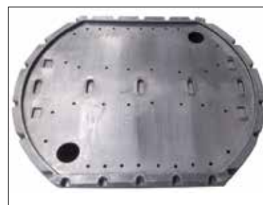
Om vloeistoffen uit het afval te laten lopen is de scharnierende bodem voorzien van een dubbele bodem met een opslagcapaciteit van 200 liter.
