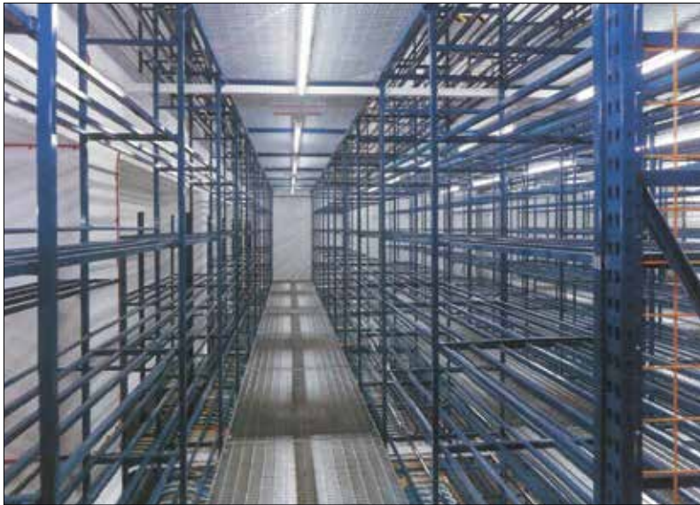
2 verdiepingen Protub stellingen met gangpaden.
