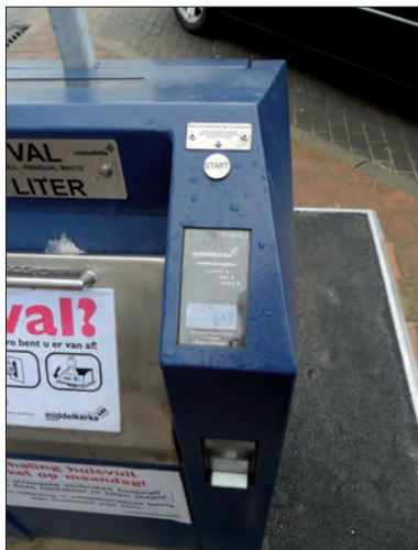
Toegangscontrole met muntautomaat op een ondergrondse container (Gemeente Middelkerke, BE).
