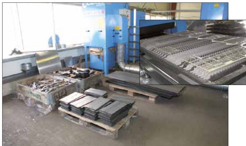
Les pièces sont découpées au laser. Rapide et moderne.
