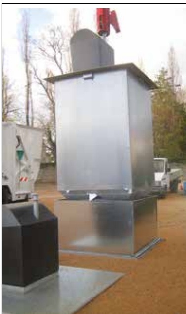
Dès que le conteneur est soulevé, le dispositif de sécurité apparaît.
