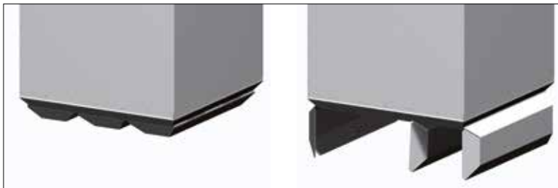
Trappes de fond 3 types de verre, possible uniquement avec système de préhension à trois crochets.
