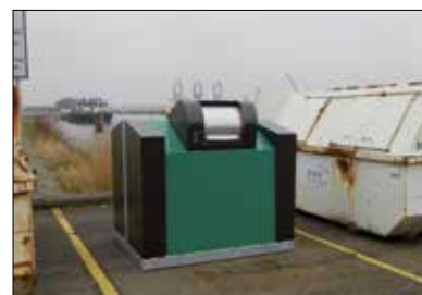
Engels a installé 28 conteneurs Aero à différentes écluses pour les déchets des bateaux de navigation intérieure. Les conteneurs Aero sont dotés d'un contrôle d'accès basé sur le principe du « pollueur payeur ».
