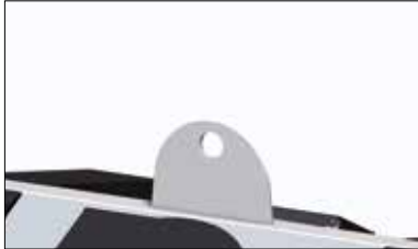
Système de préhension à crochet unique.
