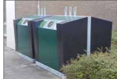
Les trous pour l'insertion du verre et/ou du papier sont finis avec une ouverture en plastique ou en acier inoxydable avec un clapet en caoutchouc ou en acier inoxydable.
